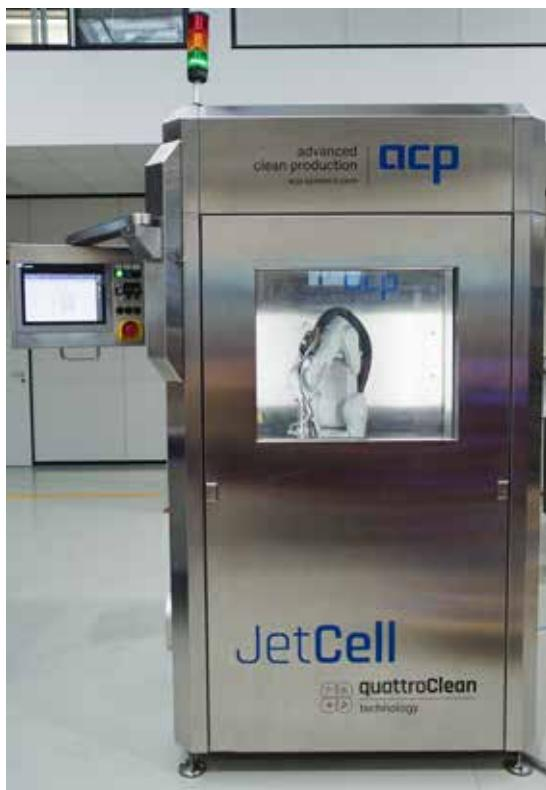
Conçue pour une utilisation en salle blanche, la cellule de nettoyage compacte JetCell-HP dotée de la technologie de jet de neige sèche quattroClean permet d'effectuer automatiquement un large éventail de tâches de nettoyage de haute pureté.
