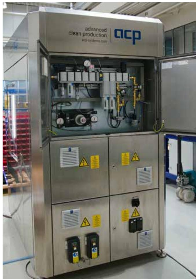
Outre l'unité de commande, la technologie complète du processus de jet de neige et de la préparation des médias est également intégrée dans le boîtier du système de la solution de nettoyage plug-and-play. Les raccordements pour l'électricité, l'air comprimé et le dioxyde de carbone sont également prévus.
