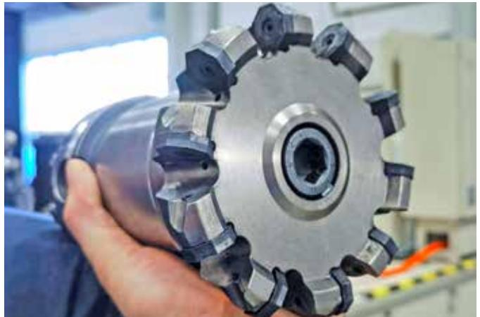
La fraise à surfacer NeoMill a un diamètre de 125 mm et est équipée de dix plaquettes indexables.
