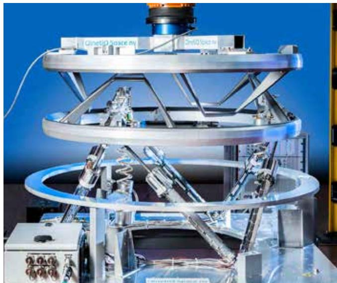
L'International Berthing and Docking Mechanism (IBDM) est le mécanisme européen androgyn d'amarrage à faible impact capable d'accoster et d'amarrer de petits et grands engins spatiaux.
