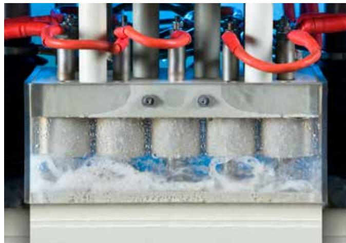
La production d'arbres de vélos électriques utilise un système d'outils à cinq cathodes actives pour fabriquer cinq arbres en parallèle.
