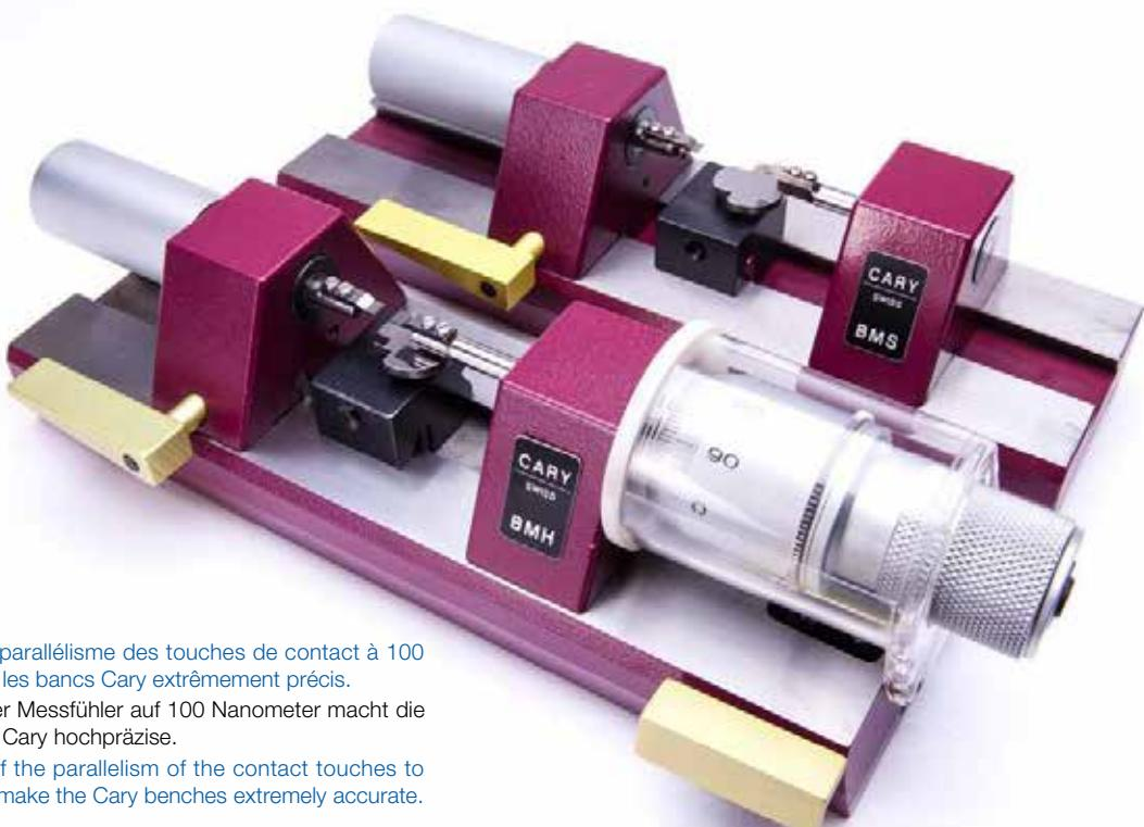
L'ajustement du parallélisme des touches de contact à 100 nanomètres rend les bancs Cary extrêmement précis.
