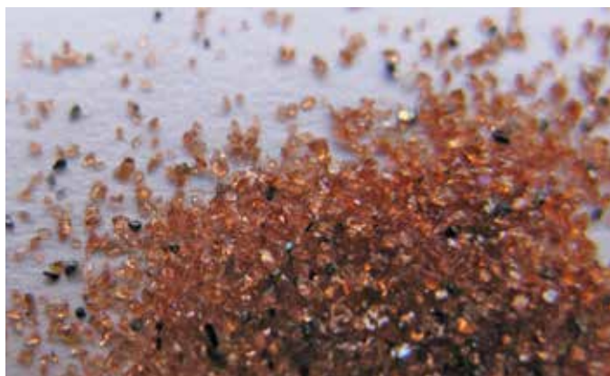
Le sable grenat de différentes granulométries est l'abrasif préféré pour la découpe au jet d'eau.
