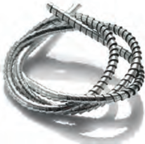
Spanbildung mit herkömmlicher Bearbeitung Formation du copeau par un usinage conventionnel
