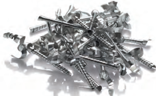
Spanbildung mit High-Frequency-Turning Formation du copeau avec High-Frequency-Turning
