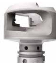
Le temps d'usinage a été réduit de 50 %. En outre, la conception du canal de refroidissement a également été optimisée. Le nouvel outil cloche est de conception hybride. Grâce à la fusion sélective au laser, la nouvelle géométrie de l'outil est imprimée sur un corps d'outil très précis avec une connexion HSK-63. La pièce fabriquée en additif est ensuite usinée de manière conventionnelle. Les inserts en PCD sont ensuite brasés et découpés au laser.
