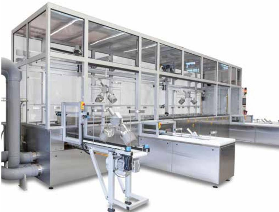
Système combiné avec nettoyage par ultrasons et séchage par condensation : durée de cycle de 6 minutes et température de séchage de 40 ° C.
