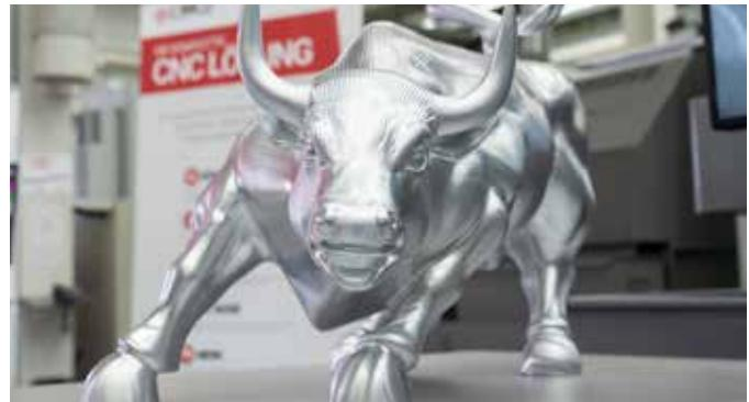
Le défi de cette tâche complexe d'usinage simultané 5 axes consiste à tourner la pièce brute dans la zone de travail de la C 650 (X-Y-Z 1050 x 900 x 600 mm) en deux axes (zone d'interférence 1100 mm) et à la faire pivoter et à l'usiner sans collision (plage de pivotement +/-115°).
