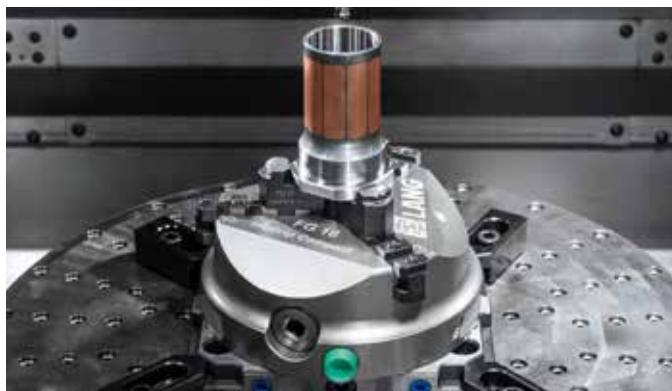
«Je nach Geometrie liegt das Größenlimit für den additiven Prozess bei je 600 Millimetern in der Länge und Breite. In der Regel sind die Bauteile jedoch kleiner», erläutert Derntl. Besonders eignet sich die Maschine auch zur Herstellung zylindrischer oder konischer Bauteile wie zum Beispiel gekühlte Vorkammerbuchsen. Durch Materialauftrag bei rotierendem Bauteil werden Taschen und Kanäle effizient gefüllt und mit Werkzeugstahl eingeschlossen.
