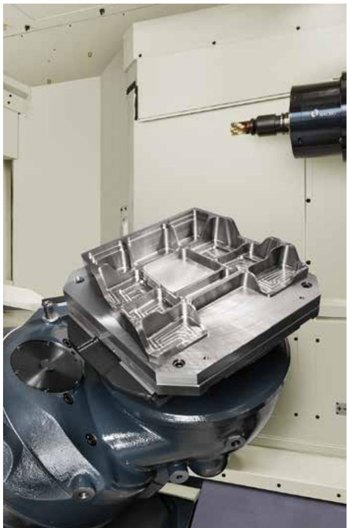
Présenté à l'EMO, le Makino a500Z: une production fiabilisée et efficace avec la flexibilité du travail en 5 axes.
