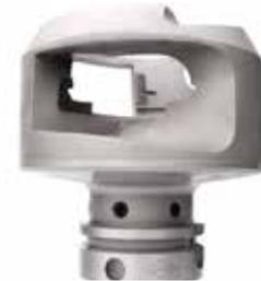
Le temps d'usinage a été réduit de 50 %. En outre, la conception du canal de refroidissement a également été optimisée. Le nouvel outil cloche est de conception hybride. Grâce à la fusion sélective au laser, la nouvelle géométrie de l'outil est imprimée sur un corps d'outil très précis avec une connexion HSK-63. La pièce fabriquée en additif est ensuite usinée de manière conventionnelle. Les inserts en PCD sont ensuite brasés et découpés au laser.
