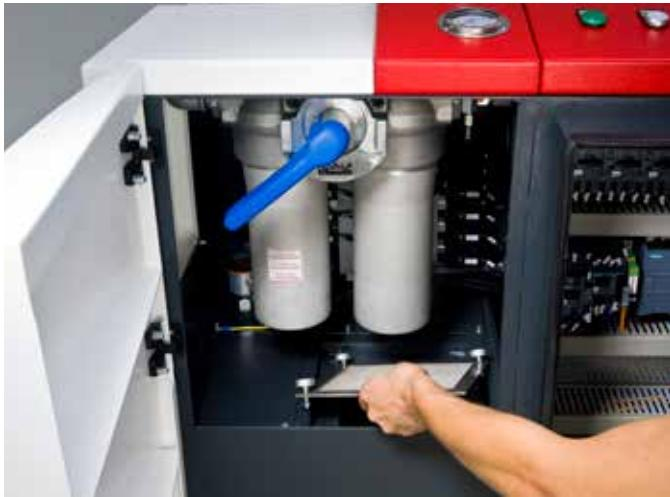
combiloop CL2 G – Pour le service continu jusqu'à 100 bars. Système de cuve à 3 chambres.
