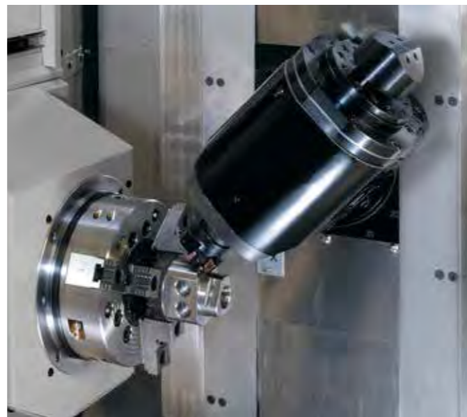
TMA8FE avec indexage de l'axe B de -15° à 195°.
