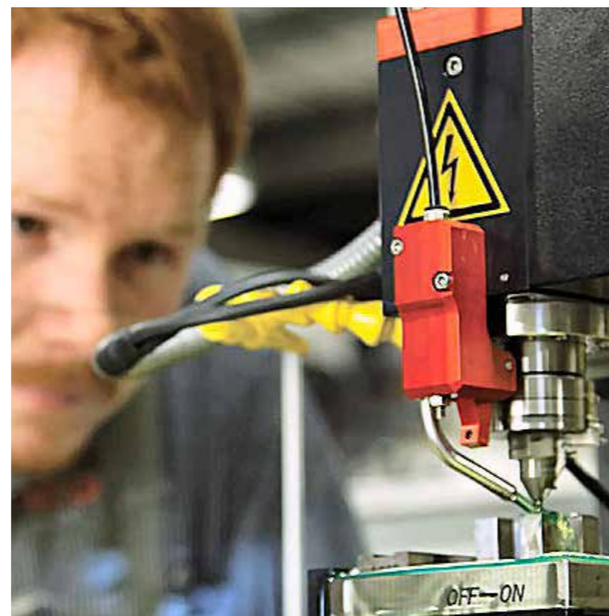
Broche rotative à haute précision avec avance et compensation d'usure automatique d'électrode.
