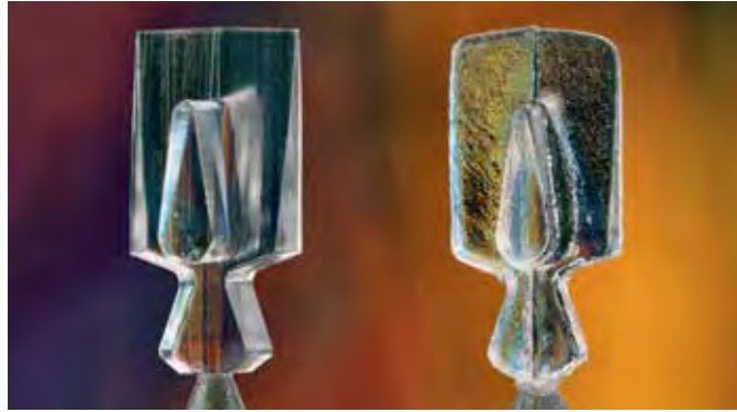
Différences majeures de résultats de qualité et de précision de forme entre le Micro Fraisage 3D par Micro EDM (à droite) et l'enfonçage EDM (à gauche)
