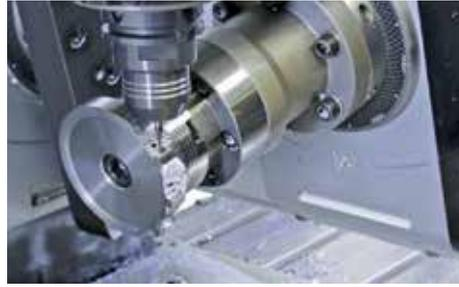
chargement et le déchargement totalement automatisés par un robot. La gamme est divisée en tables rotatives à engrenages et à entraînement direct, et elle offre de très nombreuses possibilités grâce au système modulaire.
