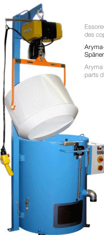
Essoreuse Aryma pour le déshuileage des copeaux et des pièces.
