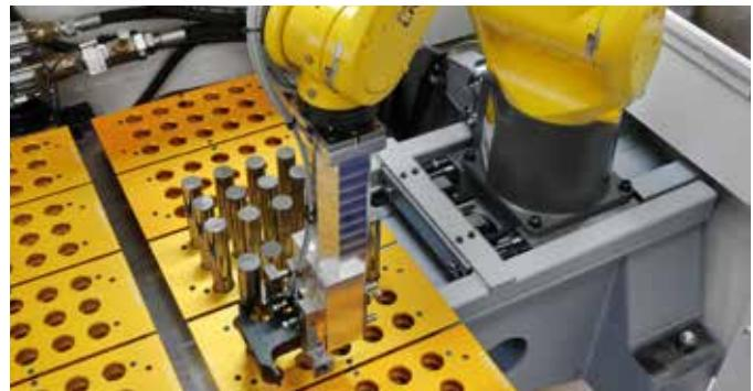
Dans son enceinte de travail, le robot Fanuc LR Mate 200iD 7L range l'outil fini sur une palette et se prépare à l'opération de chargement suivante. L'opérateur peut charger les palettes en temps masqué, et la configuration de la machine est prête pour une intégration dans un environnement 4.0, entièrement robotisée.
