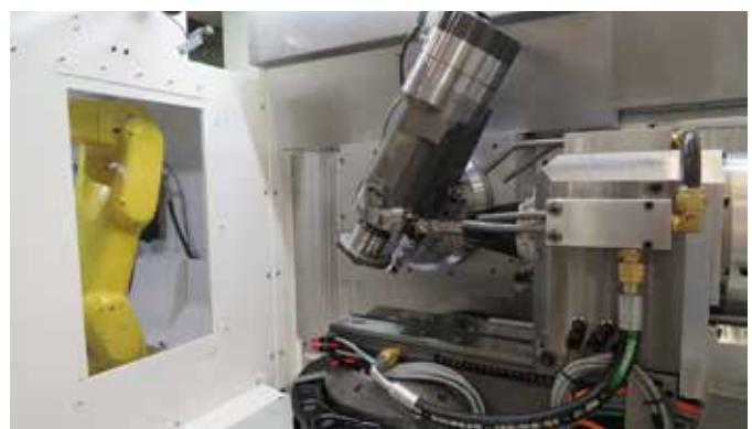
Dans une enceinte compacte, la cinématique de la Grindsmart 830XW permet la réalisation précise et performante d'outils de 1mm à 32mm, avec hélice à droite et à gauche. Le robot Fanuc LR Mate 200iD 7I peut assurer des opérations complémentaires pendant la rectification des outils.
