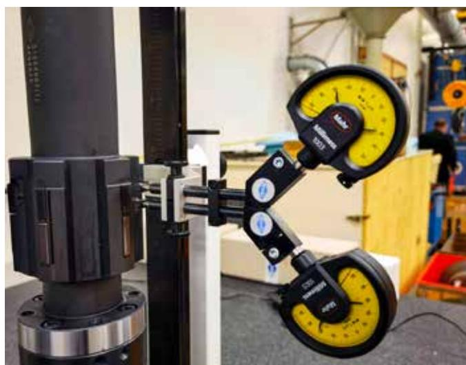
Le dispositif de réglage permet de vérifier et de régler la position radiale et l'angle des plaquettes par rapport à la direction de l'axe longitudinal à l'aide de comparateurs à cadran très précis.
