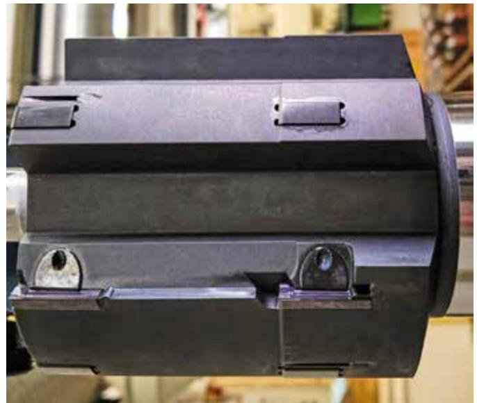
Dans la zone avant, l'outil dispose de deux plaquettes indexables pour les diamètres 99 et 98 mm. Les deux plaquettes peuvent être réglées radialement et en angle par rapport à l'axe longitudinal.
