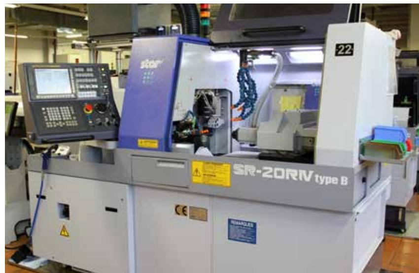
Grâce à leur construction à l'ancienne, avec notamment un châssis en fonte, les machines Star de la série SR font partie des machines les plus stables du marché.
