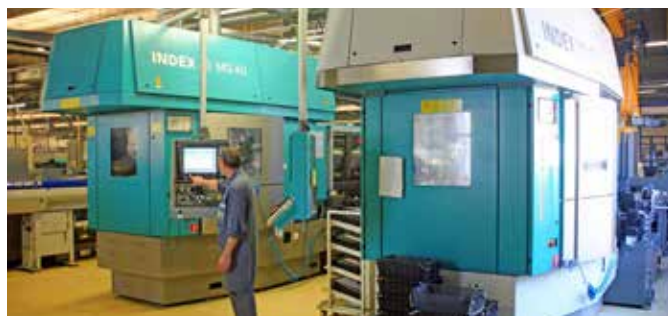
JCM Décolletage dispose désormais d'un deuxième tour multibroches INDEX MS40C.
