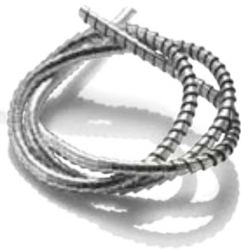
Spanbildung mit herkömmlicher Bearbeitung Formation du copeau par un usinage conventionnel
