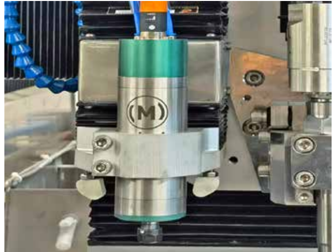
La broche haute fréquence de 50'000 tr/min est intégrée dans la commande de la machine.
